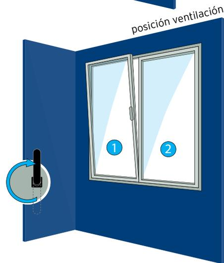
Para abrir la hoja pasiva, la hoja activa tiene que estar completamente abierta hacia el interior. La hoja pasiva está equipada con puntos de cierre o con un mecanismo de bloqueo central. Al desbloquear estos puntos de cierre o el mecanismo de bloqueo central, se puede abrir la hoja pasiva en posición batiente. Para cerrar la ventana, basta con invertir el orden.
