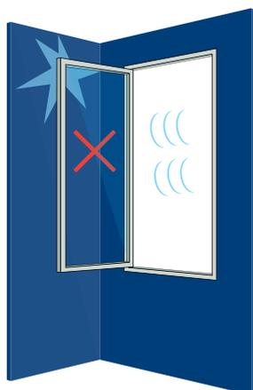
Las hojas que golpean de forma incontrolada (p. ej. a causa del viento) contra una pared pueden dañar el bastidor, los accesorios o la pared. Recomendación: utilice un limitador de apertura (regula la distancia de apertura) o un tope de puerta.
