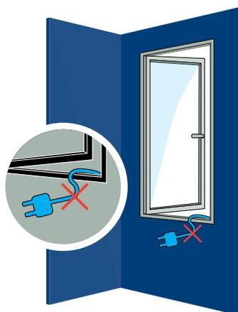
Los obstáculos (p. ej. cables, macetas) en el área de apertura entre el marco y la hoja pueden deformar y dañar los cerramientos y los accesorios.
