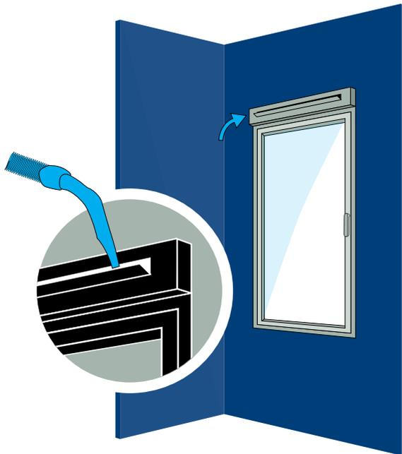
1. Abra completamente la tapa de la rejilla de ventilación.
