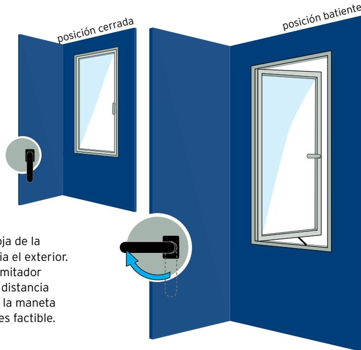
Al accionar la maneta, la hoja de la ventana se puede abrir hacia el exterior. Se recomienda utilizar un limitador de apertura para regular la distancia de apertura. La posición de la maneta apuntando hacia arriba no es factible.
