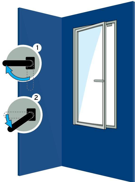
La ventana con apertura hacia el interior puede equiparse con un dispositivo de ventilación. Este pequeño espacio de ventilación se puede conseguir en primer lugar poniendo la ventana en posición batiente y abriéndola ligeramente ( $\pm 5$  mm). Posteriormente, la maneta de la ventana se debe empujar  $45^\circ$  hacia abajo. De esta forma la ventana se pone en una posición de ventilación fija con un hueco reducido de apertura de  $\pm 5$  mm.
