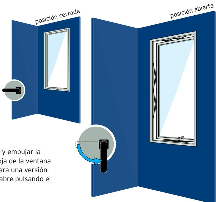
Al accionar la(s) maneta(s) y empujar la ventana hacia afuera, la hoja de la ventana se abre hacia el exterior. Para una versión motorizada, la ventana se abre pulsando el botón.
