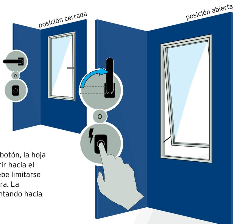
Al accionar la maneta o el botón, la hoja de la ventana se puede abrir hacia el exterior. La hoja abierta debe limitarse con un limitador de apertura. La posición de la maneta apuntando hacia abajo no es factible.
