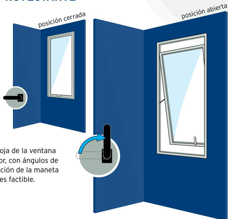
Al accionar la maneta, la hoja de la ventana se proyecta hacia el exterior, con ángulos de apertura limitados. La posición de la maneta apuntando hacia abajo no es factible.
