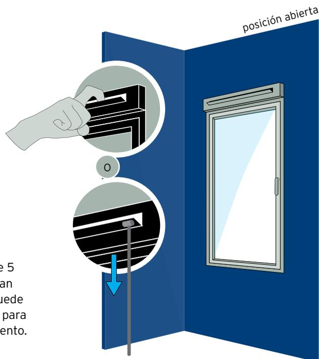
El sistema Ventalis puede regular la ventilación de una sala. Ventalis tiene 5 posiciones de apertura que determinan el nivel de flujo de aire. La aleta se puede abrir manualmente o con una varilla, para facilitar la ventilación o el mantenimiento.
